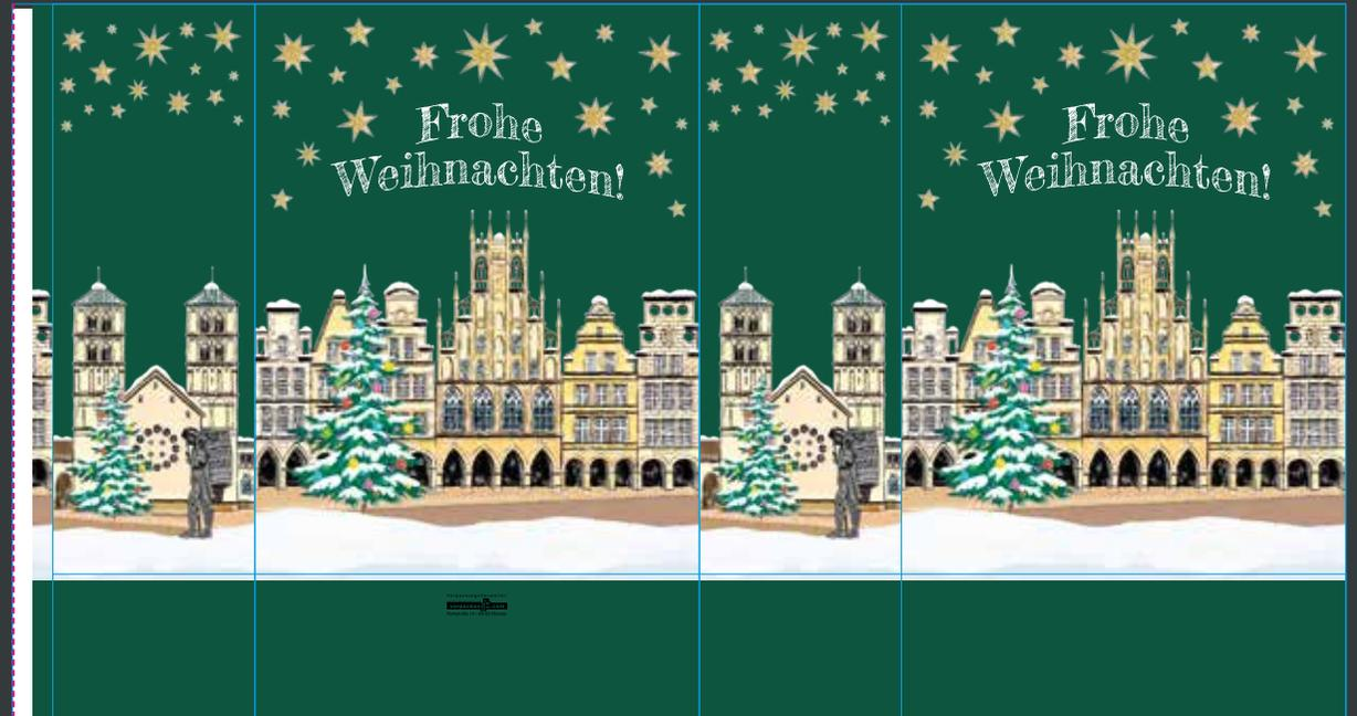
Aufbau für Papiertragetasche vom Typ Göttingen (Flachhenkel) oder Trier (gedrehte Papierkordel). Aufbau Klebnaht, Seitenfalte, Front, Seitenfalte und Rückseite. Links 20 mm Klebnaht, davon rechts 10 mm Überfüllung der Rückseite (rechts). Die Klebnaht verläuft auf der Rückseite ca. 10 mm vom rechten Rand. Hier sind Versatz in Höhe und Breite möglich. Daher sollten hier keine Logos oder Texte platziert werden.
