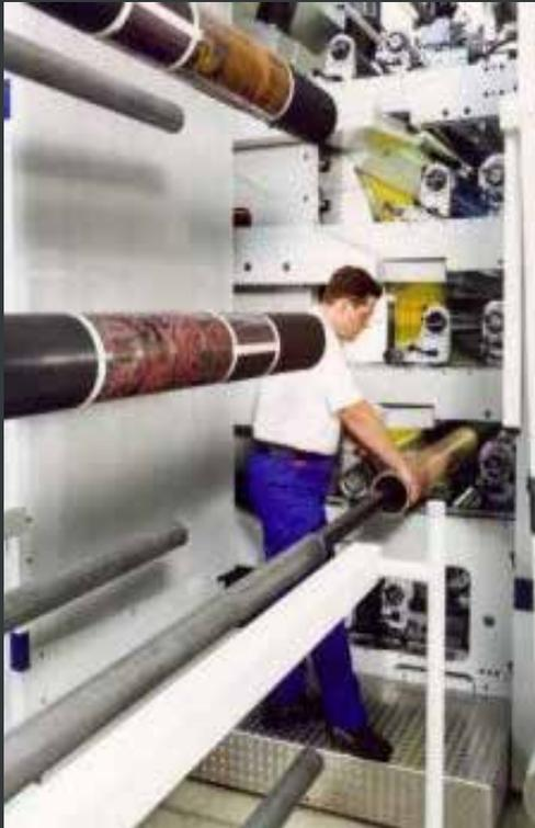
Maschineneinrichtung für den Flexodruck mit einem Sleeve.
