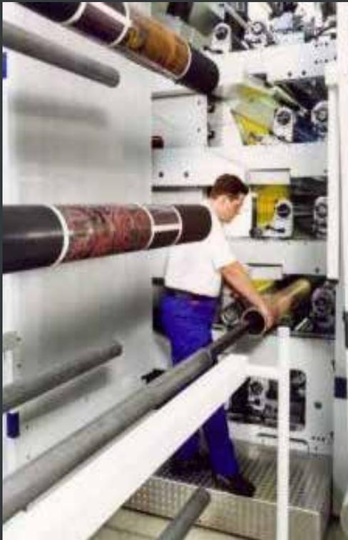
Maschineneinrichtung für den Flexodruck mit einem Sleeve.
