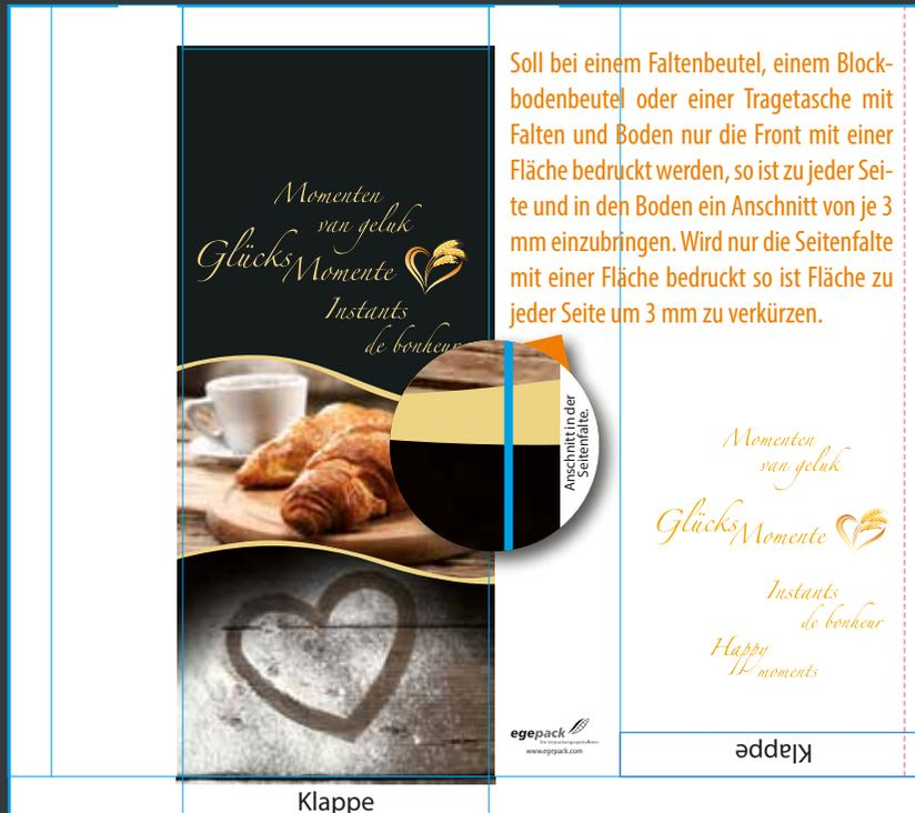
Soll bei einem Faltenbeutel, einem Blockbodenbeutel oder einer Tragetasche mit Falten und Boden nur die Front mit einer Fläche bedruckt werden, so ist zu jeder Seite und in den Boden ein Anschnitt von je 3 mm einzubringen. Wird nur die Seitenfalte mit einer Fläche bedruckt so ist Fläche zu jeder Seite um 3 mm zu verkürzen.
